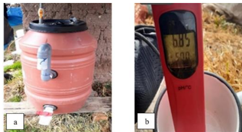
Nota. (a) Fotografía del diseño del biodigestor, (b) Medición con el Peachímetro PHMETER, modelo PH-009
