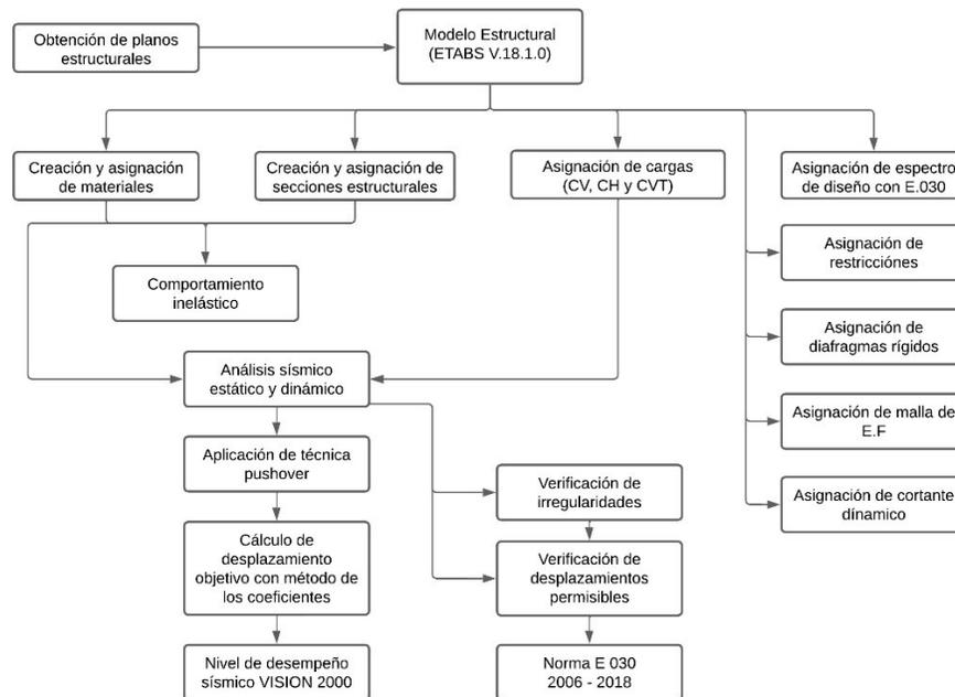
Las vigas y columnas fueron incluidas en el modelado haciendo uso de elementos tipo fibra con inelasticidad distribuida Abarca Duarte (2020), así también se consideró secciones integradas. Para el análisis estático no lineal se consideró la combinación de carga gravitacional especificada en ASCE 41-17 en concordancia con la ecuación 13.
