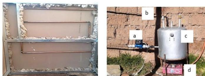
*Nota.* (a). Bomba con sus válvulas, (b). Salidas del tubo de cobre, (c). Tanque de almacenamiento, (d) hornilla para calentar el aceite.
